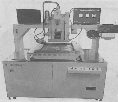
大型基板対応リワーク装置「MS9000XL」
