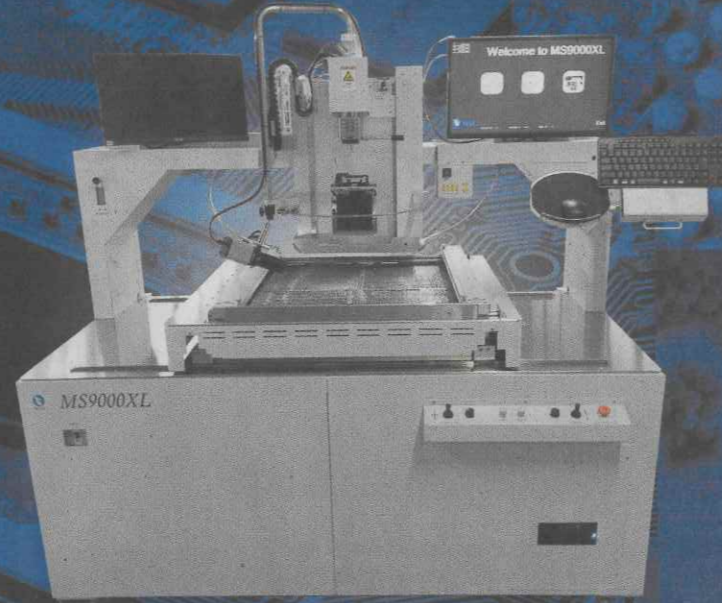
インフラ系大型多層基板用リワーク装置 MS9000XL
